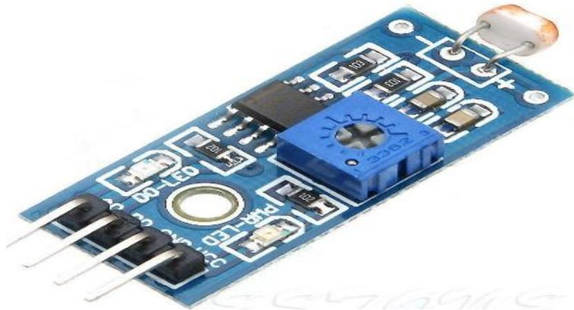
Figura 8. sensor de intensidad digital.
