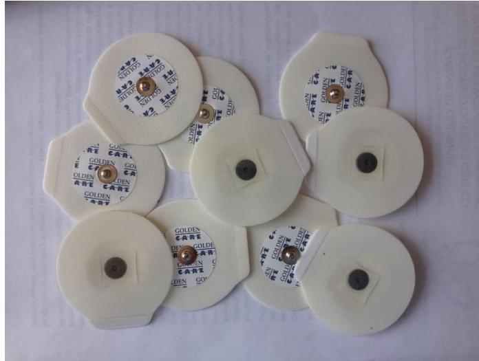
Figura 8. Electrodo adhesivo con broce. Fuente: (Autor, 2021)
